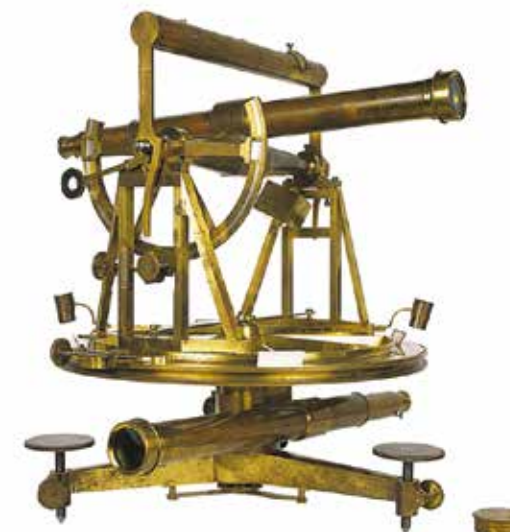
Repetitionstheodolit, 12 Zöller Math. Mechanisches Institut München, 1810
