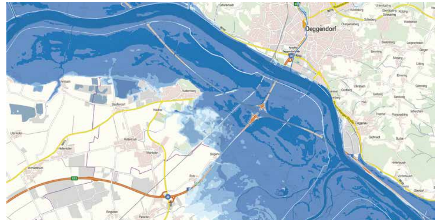
Hochwassersimulation: Wassertiefen in Deggendorf bei einem Jahrhunderthochwasser (HQ100)
