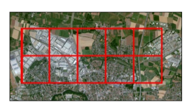
Orthophoto Ein quadratisches Koordinatengitter wird lagerichtig abgebildet. Das Orthophoto ist deckungsgleich mit einer Karte gleichen Maßstabs.
