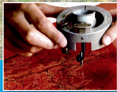
Schichtgravur auf Glas mit Gravurstichel und eingegravierten Datenstichel © Landesamt für Digitalisierung, Breitband und Vermessung
