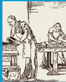
Lithograpf bei der Aufarbeitung des Lithografiesteindrucks für den Druck Z. Zeichnung: Engelmann, Offset-Druck in der Praxis
